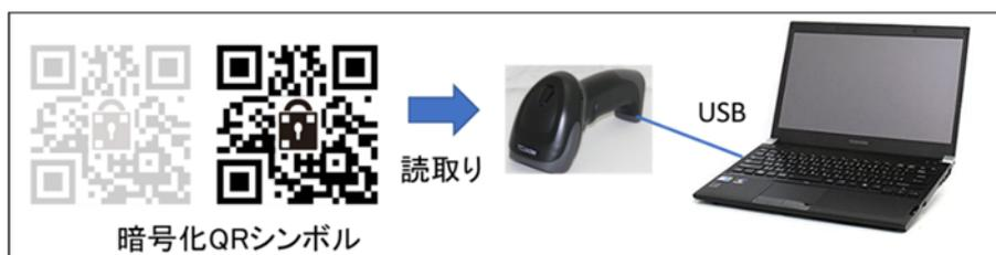
第8図 専用スキャナによる検証システム
